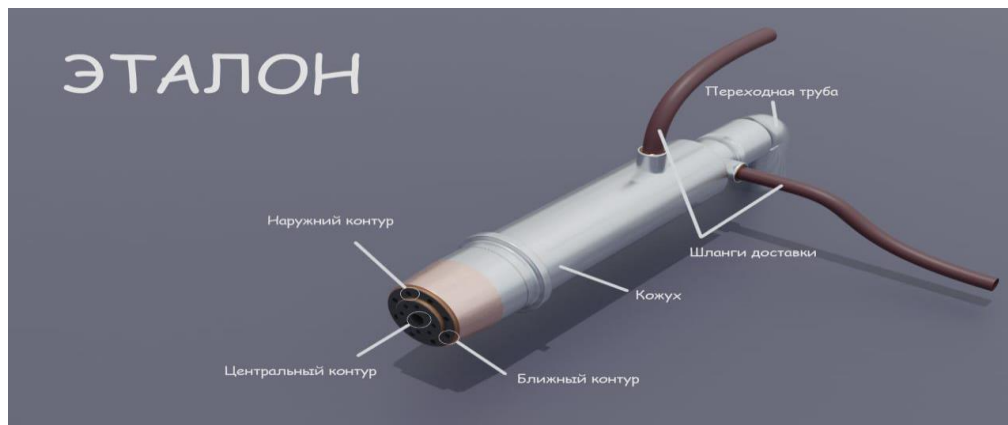
Рисунок 4 – Модель комбинированной газокислородной горелки участка выплавки стали
