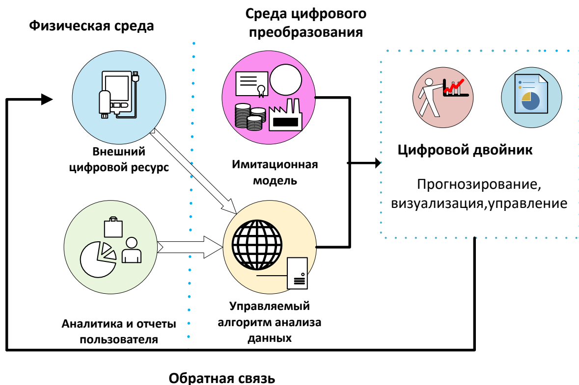
Рисунок 1 - Модель цифрового двойника, в системе имитационного моделирования
